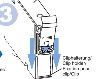
Tintentank/Ink tank/Réervoir d'encre/Serbatoio inchiostro
